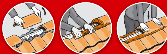
Afdichten van kilgoten Fixer des tuiles à des noues
