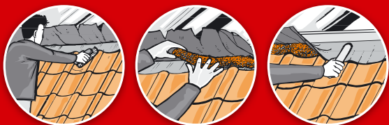
Bevestigen van gevelpannen Fixer des tuiles de rive
