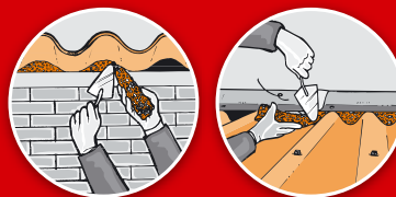
Bevestigen van golfplaten Calfeutrer des toits ondulés
