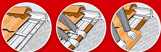
Bevestigen van gevelpannen Fixer des tuiles de rive
